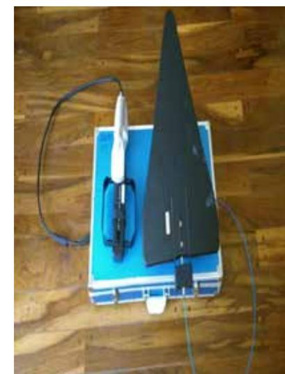
Imagen 2. Cazador de interferencias y juego de antenas para monitoreo de diferentes bandas del espectro
